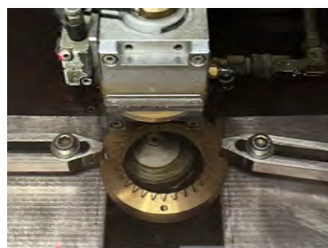
ワイヤーカット放電加工機による荒加工
